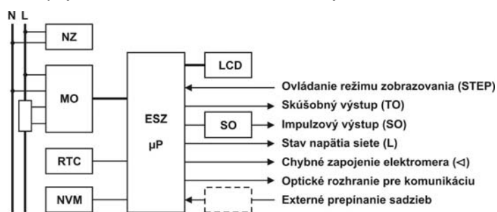
Obr. 1 – Bloková schéma zapojenia elektromera AMS B1x xAx
