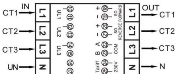
Ujistěte se, že vodič je připojen směrem vpravo (podle toku proudu). Pokud je MTP zapojeno nesprávně, elektroměr měří v opačném směru (dodávku energie).
